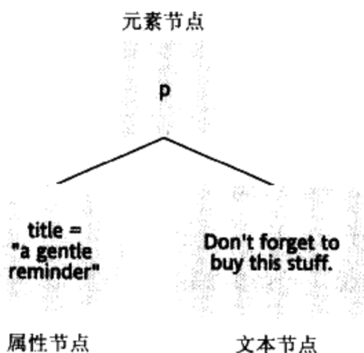
图 3-2 一个元素节点，它包含着一个属性节点和一个文本节点
